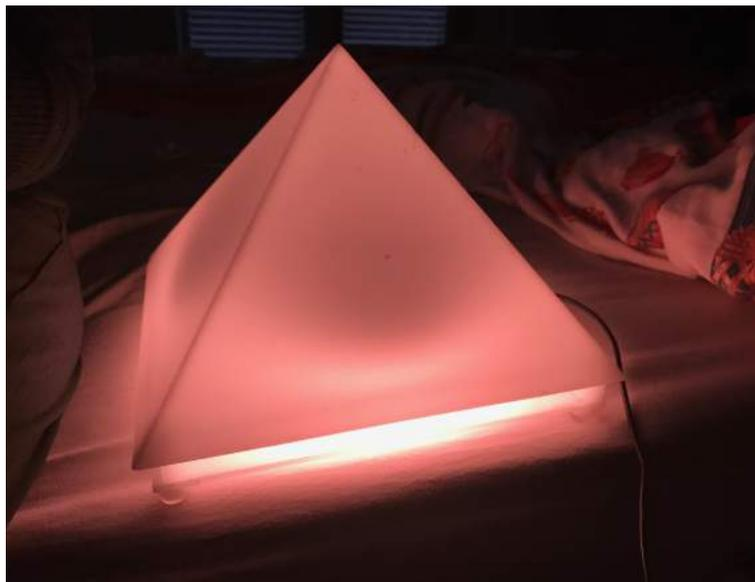
Il LED RGB possedendo incorporate tre sezioni emittenti caratterizzate da emissione di luce di colore Rosso, Verde e Blu, permette di ottenere tramite la regolazione dell'emissione delle tre sezioni unitamente ad un opportuno diffusore, luce colorata nell'intera gamma cromatica visibile, anche con caratteristiche dinamiche (pulsata e sweep), indispensabili per i moderni trattamenti cromoterapici.
